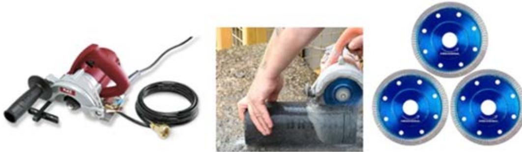
Les tuyaux en fibrociment se coupent facilement à l'aide d'une scie abrasive connecté soit à de l'eau, soit à un aspirateur à haute efficacité. Les bouts seront coupés à l'angle droit et à l'équerre de sorte que l'engagement soit constant dans le joint mécanique.
